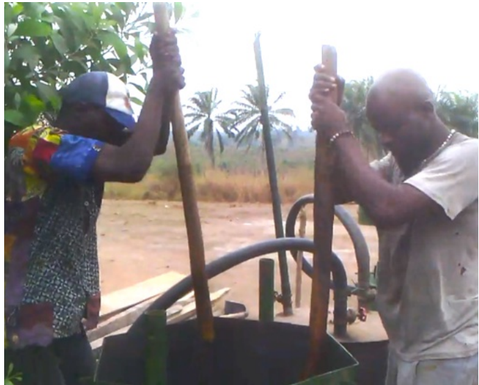
I frutti di palma sterilizzati vengono prima rotti e poi spremuti
